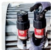
**La pressione di 7,5 bar** consente il montaggio fino a 5 m di distanza
