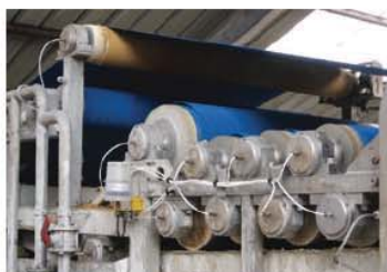
Industria Alimentare: lubrificazione di cuscinetti a sfera
