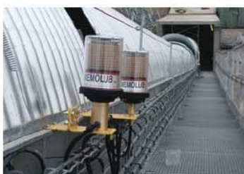
Industria mineraria: lubrificazione cuscinetti dei nastri trasportatori
