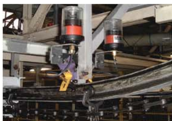
Industria automobilistica: lubrificazione dei rulli per i nastri trasportatori aerei e rotaie.
