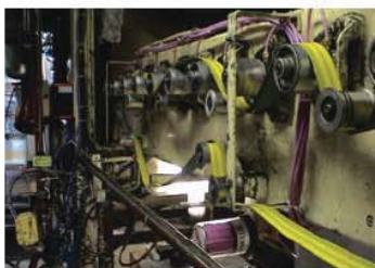
Industria metallurgica: lubrificazione dei cuscinetti a rulli su un laminatoio per alluminio.
