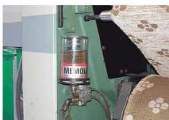
Industria tessile: Cuscinetti per telai Picanol
